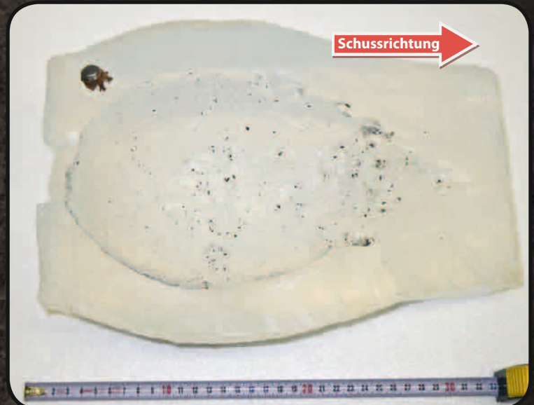
165 gr. Interbond in .30-06 Superformance auf Seifenblock
