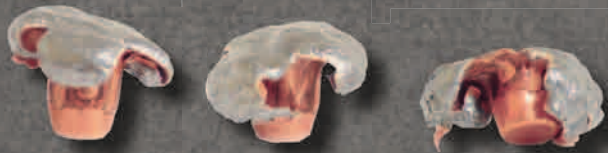
Interbondgeschoß auf 50m, 100m und 200m
